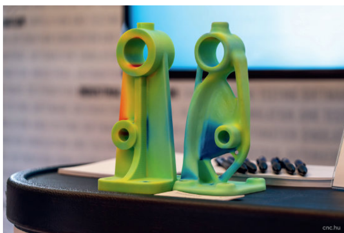
Slika - Primer topološki optimizovanog modela korišćenjem softvera Ansys® Discovery a) izgled modela pre topološke optimizacije b) izgled modela nakon postupka topološke optimizacije c) primer izrađenih 3D modela pre i posle procesa topološke optimizacije
